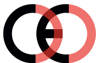
Valse CE-markering (te dichtbij)
